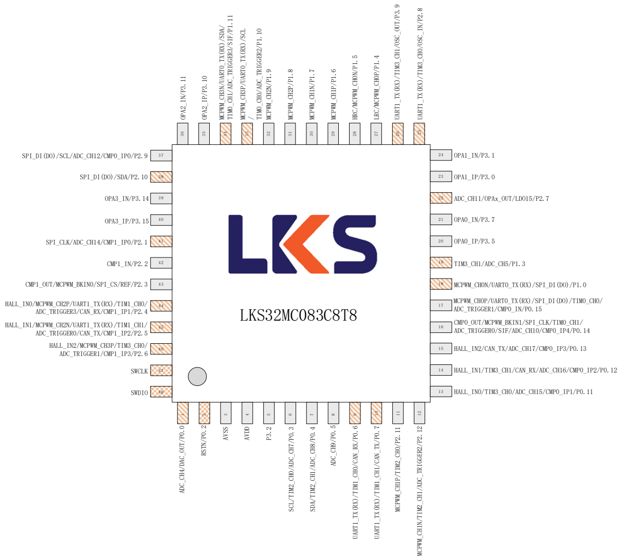
图 3-4 LKS32MC083C8T8 管脚分布图
