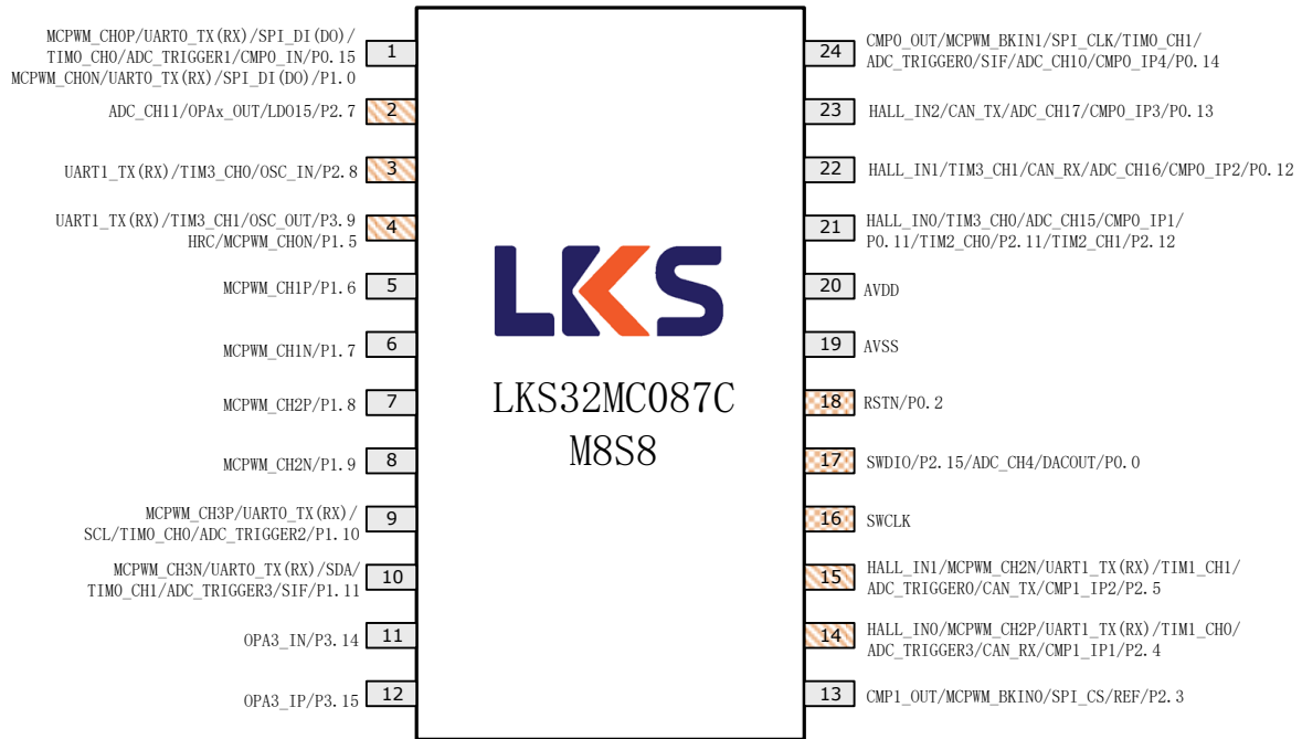
图 3-7 LKS32MC087CM8S8 管脚分布图
