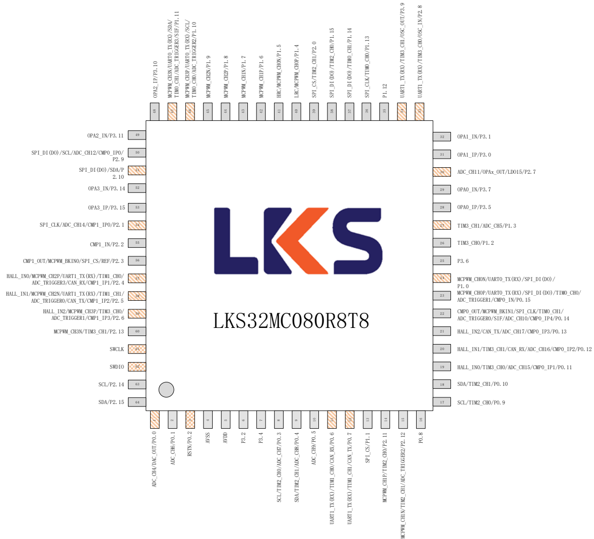
图 3-1 LKS32MC080R8T8 管脚分布图
